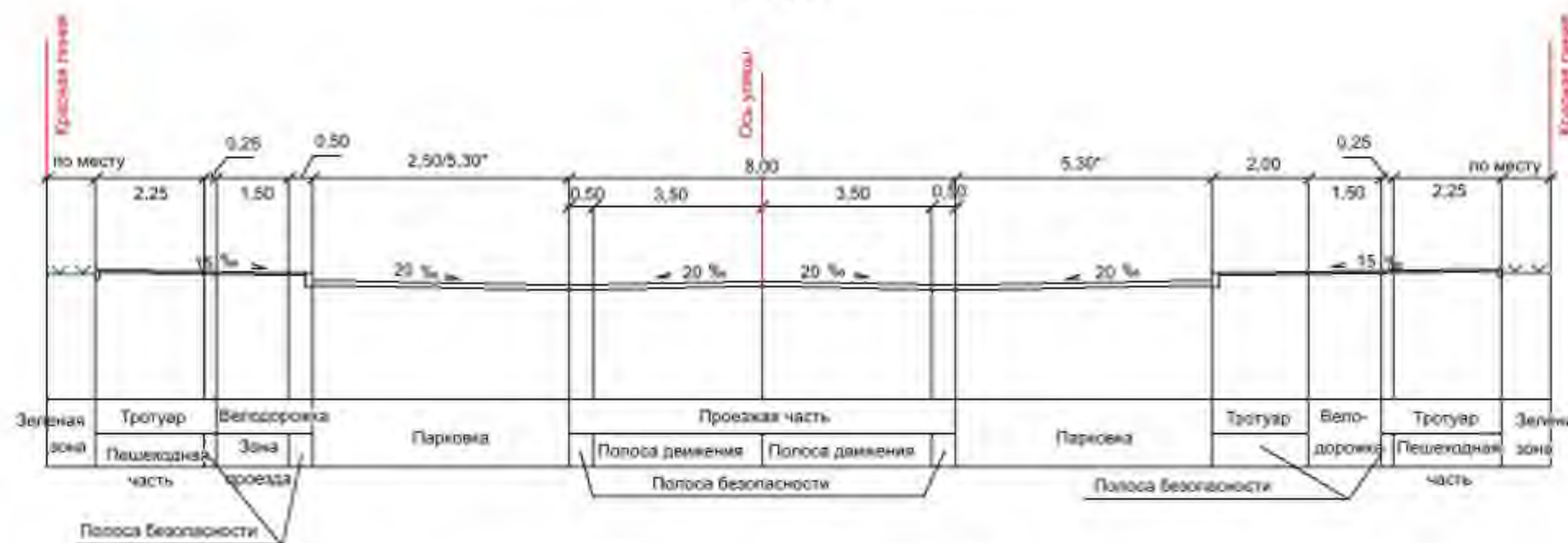
Поперечный профиль улицы в зоне парковок М 1:100
