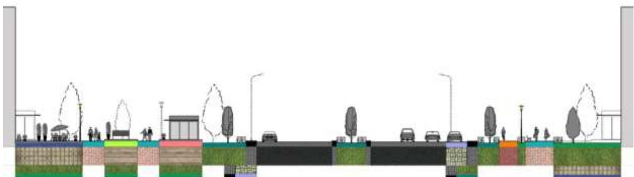
**Рисунок 46. Организация пространства улиц шириной в красных линия – 60 и более метров**
